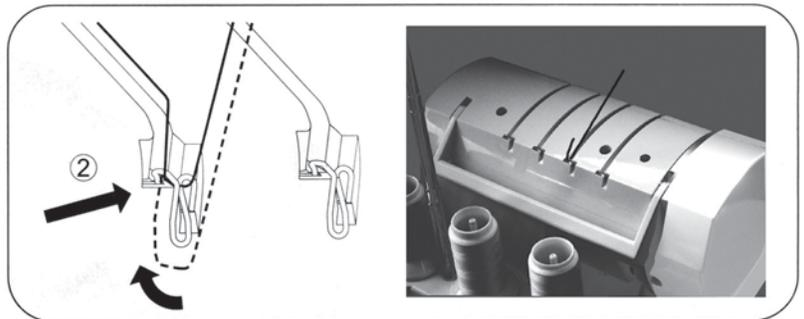
Halten Sie den Faden mit den Fingern fest, führen Sie ihn zwischen den Spannungsscheiben hindurch und ziehen Sie ihn dann nach unten, so dass er sich in korrekter Position zwischen den Spannungsscheiben 3 befindet.
